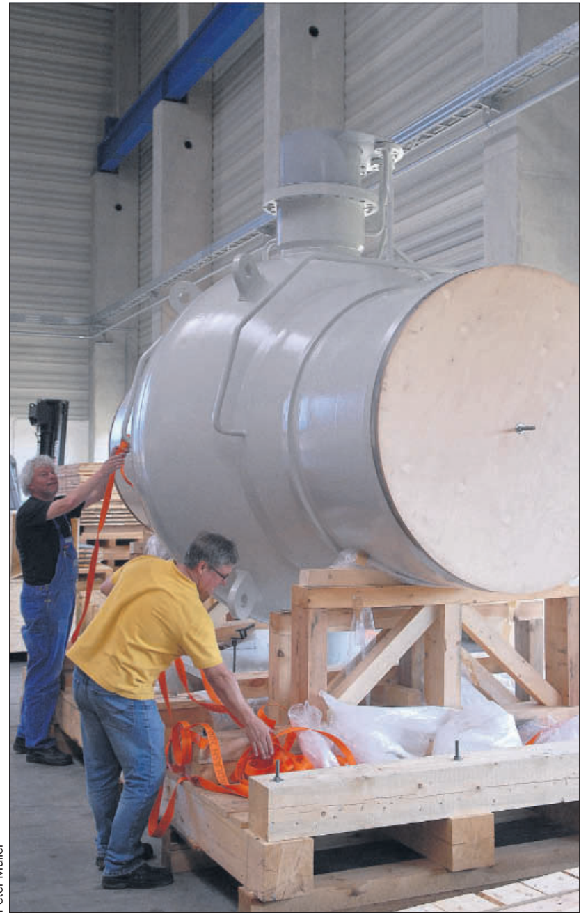
Die Bohranlage für das millionenschwere Geothermie-Projekt in St. Gallen (links). Rechts der weltgrößte Kugelhahn der ITAG-Tochter Valves & Oilfield Products GmbH mit einem Gesamtgewicht von knapp 33 Tonnen, den Ausbildungsmeister Klaus Meier (links) und Fertigungsmeister Karl-Heinz Krause in Augenschein nehmen.
